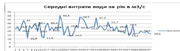
Рис. 1.1. Середньорічний стік в середній течії річки Псел (гідрологічний пост м. Суми з 1948 по 2015 рр.)
